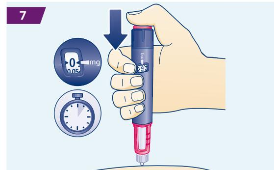
Injektionsnadel senkrecht in die Haut einstechen, Druckknopf so lange drücken, bis die Zahl 0 in der Dosisanzeige an der Markierung steht. Während Sie dies tun, können Sie womöglich einen Klick hören oder fühlen. Injektionsnadel mindestens 6 Sekunden unter der Haut belassen.
